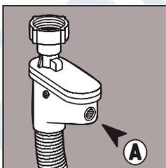
Данная система (шланг аква-контроль) – средство защиты от ущерба, причиняемого водой. В том случае, если шланг подачи воды испортится, система предотвратит подачу воды в прибор по неисправному шлангу.
