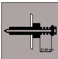
Если стиральную машину нужно снова запаковать, при затягивании винтов шпилек пружины шпилек необходимо сжать до 21-24 мм.
