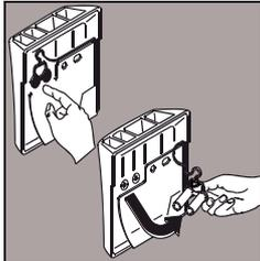
Теперь вы можете промыть дозатор под струей воды щеткой или скрученным куском ткани. Проверьте, не засорились ли сифоны на задней части дозатора.
