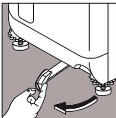
Если вы хотите переставить стиральную машину, поднимите ее на колесики – для этого поверните рычаг внизу машины влево. После того, как машина будет установлена на нужное место, установите рычаг в исходное положение.
