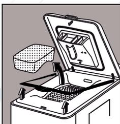
Откройте крышку стиральной машины и выньте приспособления, предотвращающие вращение барабана, и пластиковую прокладку. Закройте крышку.
